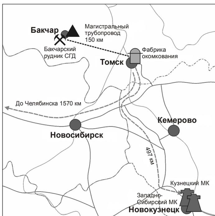
Рис. 5. Схема транспортировки бакчарской железной руды
