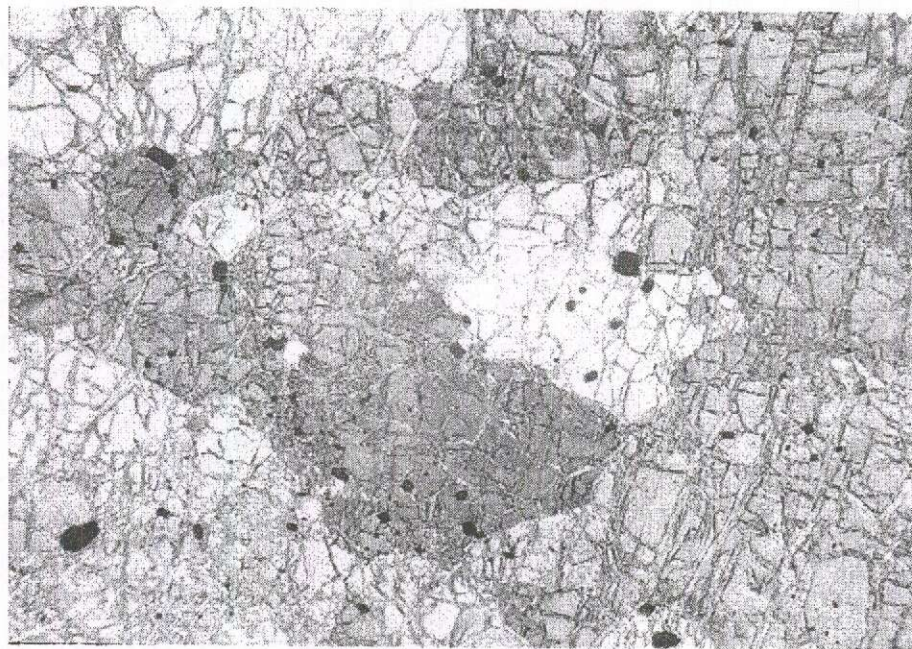
Рис. 3. Дунит II со среднезернистой гипидиоморфнозернистой структурой и акцессорной равномерно рассеянной хромитовой минерализацией:
