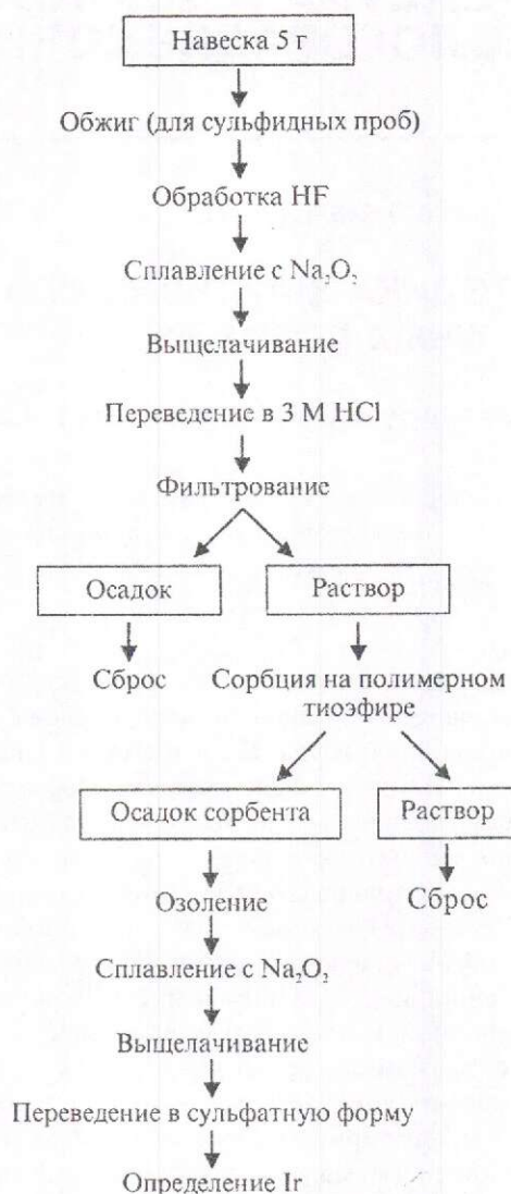
Рис. 1. Схема методики сорбционно-кинетического определения иридия
