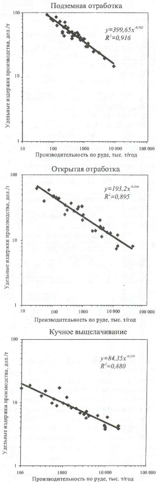
Рис. 4. Зависимости удельных издержек производства и годовой производительности предприятия по руде
