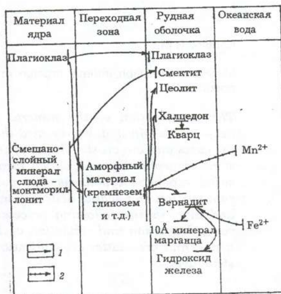
Рис. 6. Схема минералогических преобразований при формировании рудной оболочки железомарганцевой конкреции.
