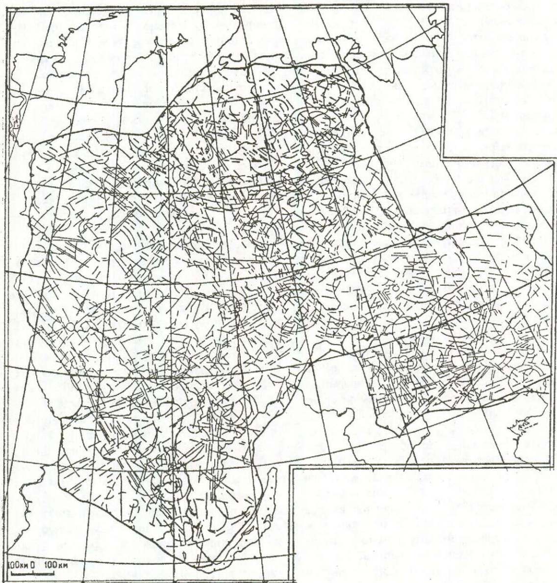
Рис. 1. Специализированная схема дешифрирования кольцевых и линейных элементов, отражающих глубинные структуры Сибирской платформы.
