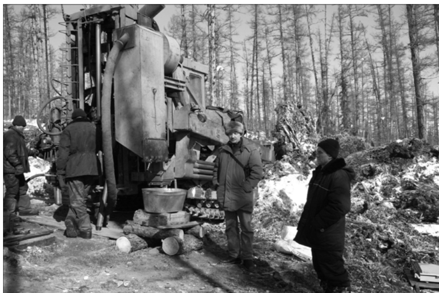
Рис. 8. Пневмоударное бурение станком BTS-150 в Бодайбинском рудном районе
