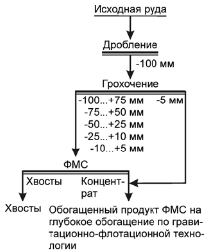
Рис. 1. Принципиальная технологическая схема фотометрической сепарации (ФМС) золотосодержащей руды
