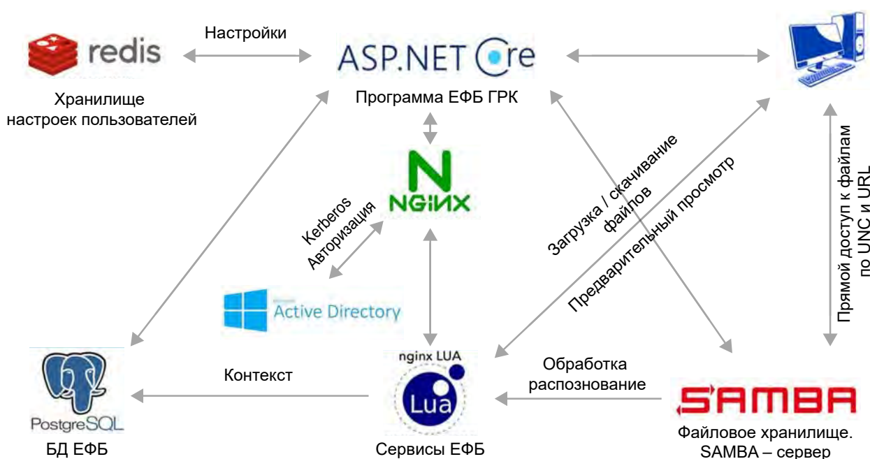
Рис. 1. Логическая архитектура информационной системы ЕФБ ГРК
