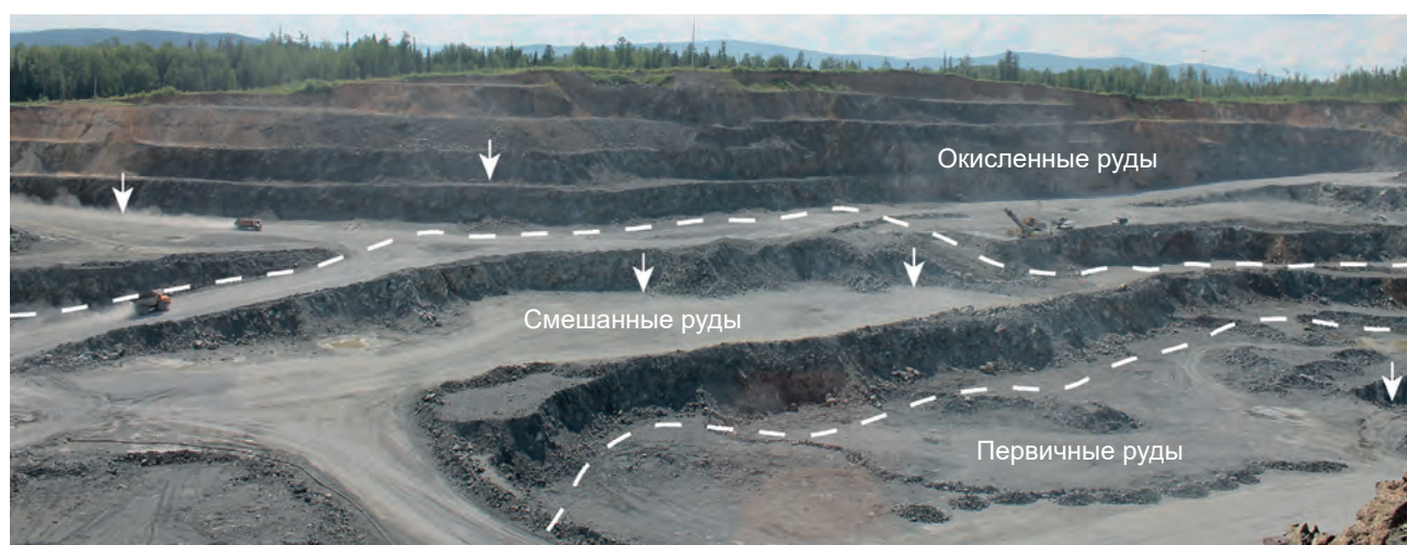
Рис. 2. Точки опробования сортов медных руд (показаны стрелками) в выделенных горизонтах балансовых первичных, смешанных и окисленных руд Северо-Западного карьера Волковского месторождения:
