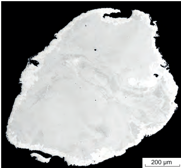
Рис. 10. Частица с высокопробной каймой по периферии (белое), т. н. 1351-3, р. Чёрная:
