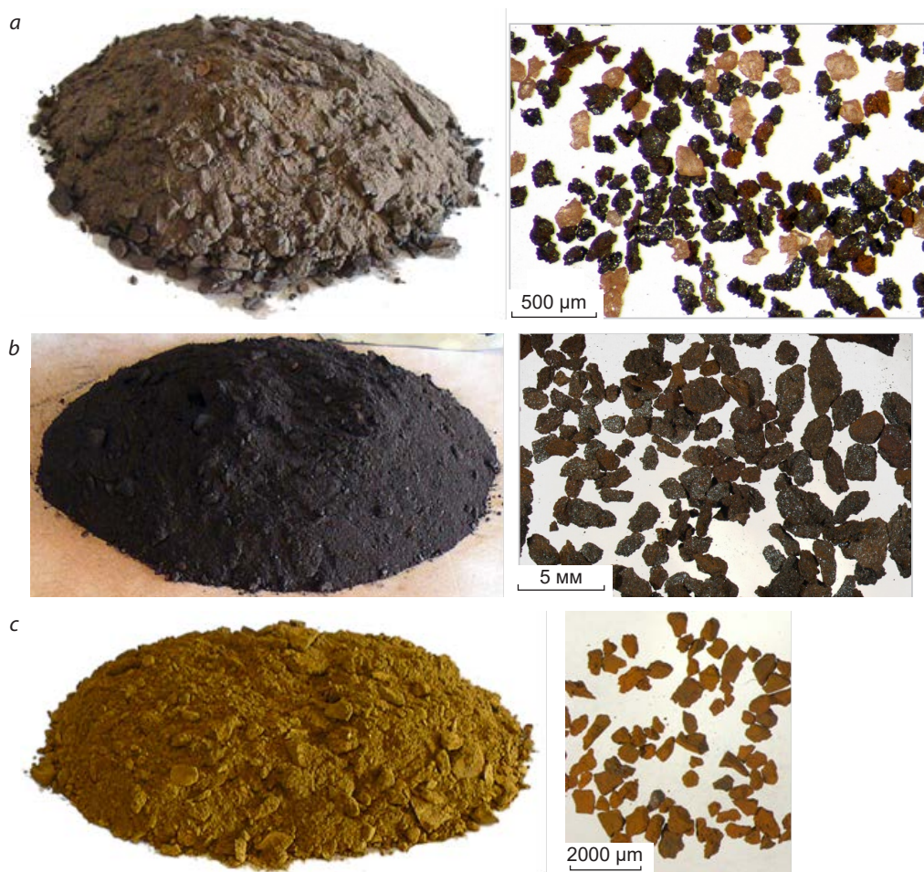
Рис. 8. Рыхлые руды месторождения Северный Симанду (слева – образец, справа – ситовая фракция): a – кварц-мартитовая руда (скв. 043 – 59 м, фракция -0,25+0,125 мм с зёрнами кварца и чёрного мартита); b – мартитовая руда (скв. 007 – 128 м, фракция +1 мм); c – мартит-лимонитовая руда (скв. 068 – 48 м, фракция -1+0,5 мм)
