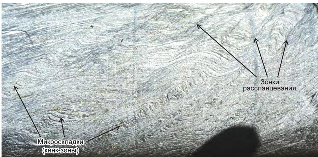
**Рис. 15. Микроскладчатая (типа кинк-зон) деформация тонкопереслаивающихся углеродистых сланцев (тёмные слойки) и алевросланцев и алевропесчаников (светлые слойки) – начальный этап формирования зонк рассланцевания. Скв. 4, 175 м. Диаметр керна 63 мм**
