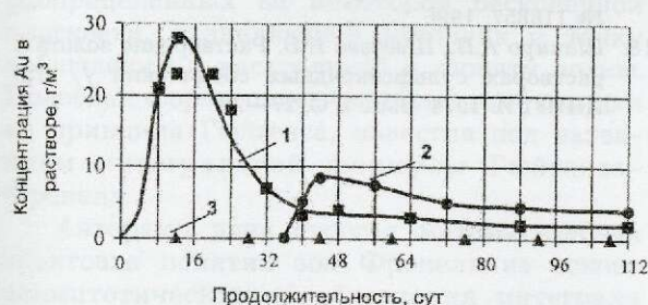
Рис. 6. Динамика кучного выщелачивания золота из блок-секций окисленной руды опытно-полупромышленной установки КВ:
