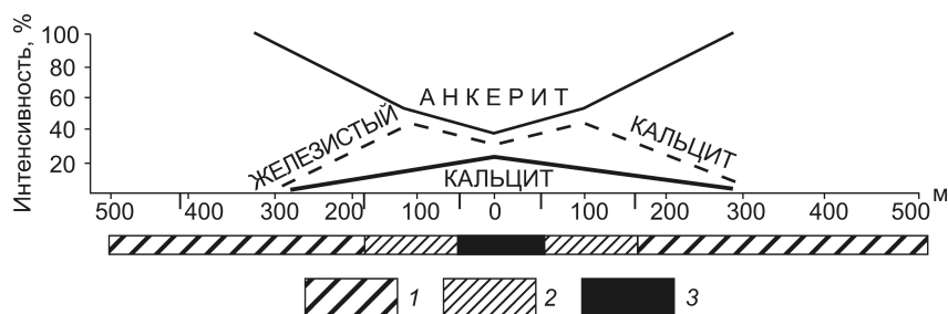
Рис. 4. Изменчивость состава карбонатов в пределах рудной зоны:
