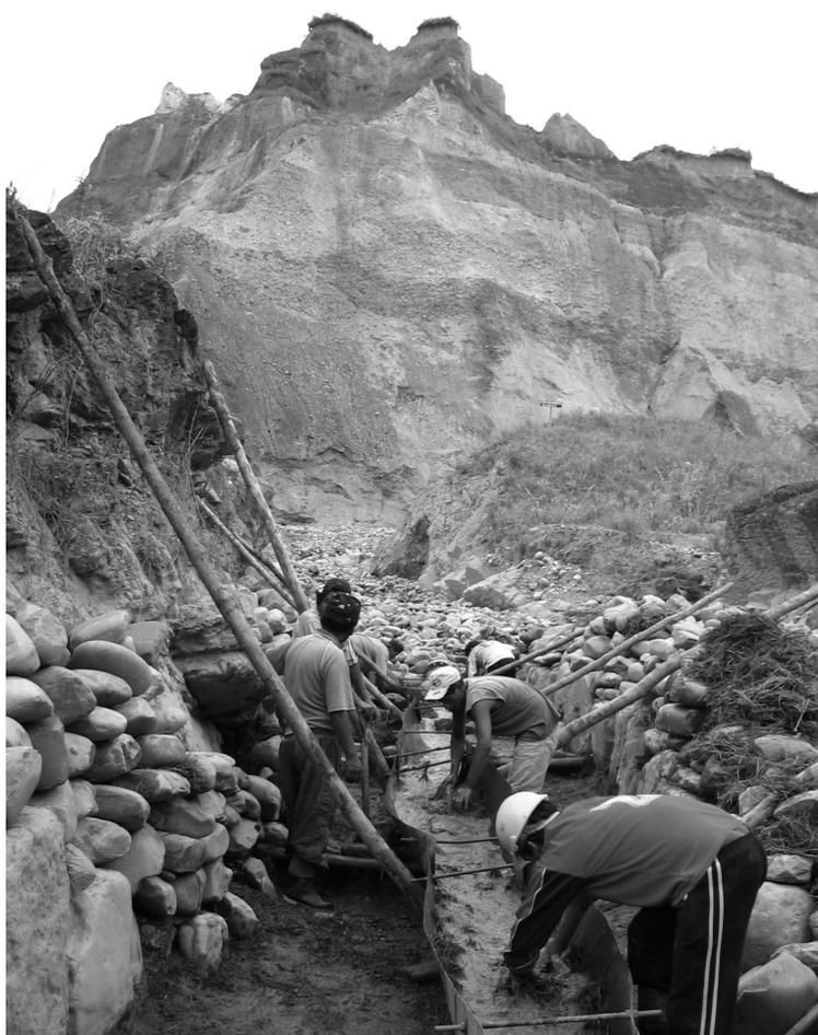
Рис. 3. Сбор концентрата из канала «кочасо», на заднем плане — стенка карьера
