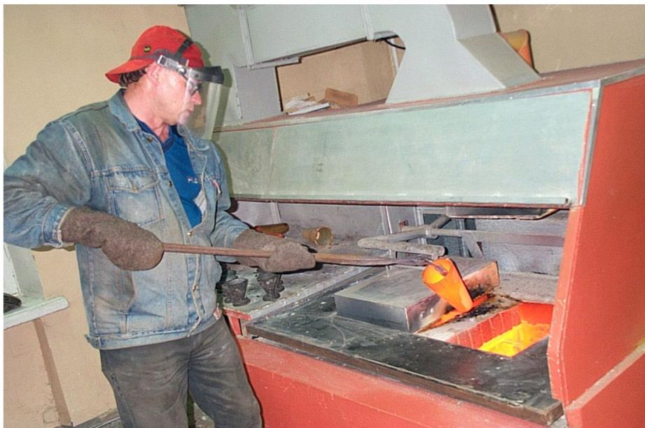
**Рис. 1. Пробирная плавка**
