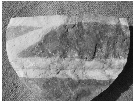
Рис. 5. Прожилково-трещинное осветление с субгоризонтальными штрихами скольжения в его плоскости и Z-образной формой в поперечном сечении (признак левого сдвига) в красноцветных мергелях из экзоконтакта с дайкой порфиrowого кимберлита (зона сочленения Мархинского и Ботубинского месторождений):
