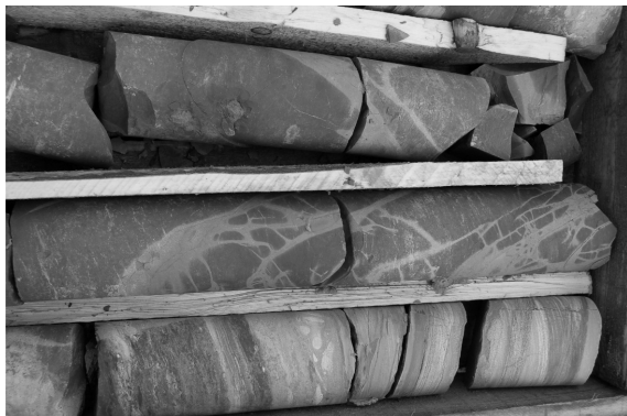
Рис. 4. Сетчатое прожилковое осветление в кембрийских породах экзоконтакта кимберлита Майского месторождения:
