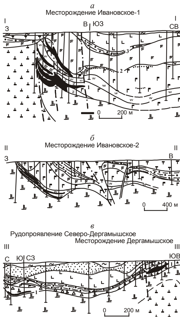
Рис. 4. Геологические разрезы: а — месторождение Ивановское-1 в западной части Центральной палеодепрессии на контакте с Ивановской протрузией второй фазы; б — месторождение Ивановское-2 в Западной палеодепрессии и серпентинитовые протрузии третьей фазы; в — Дергамышское рудное поле (продольный разрез):
