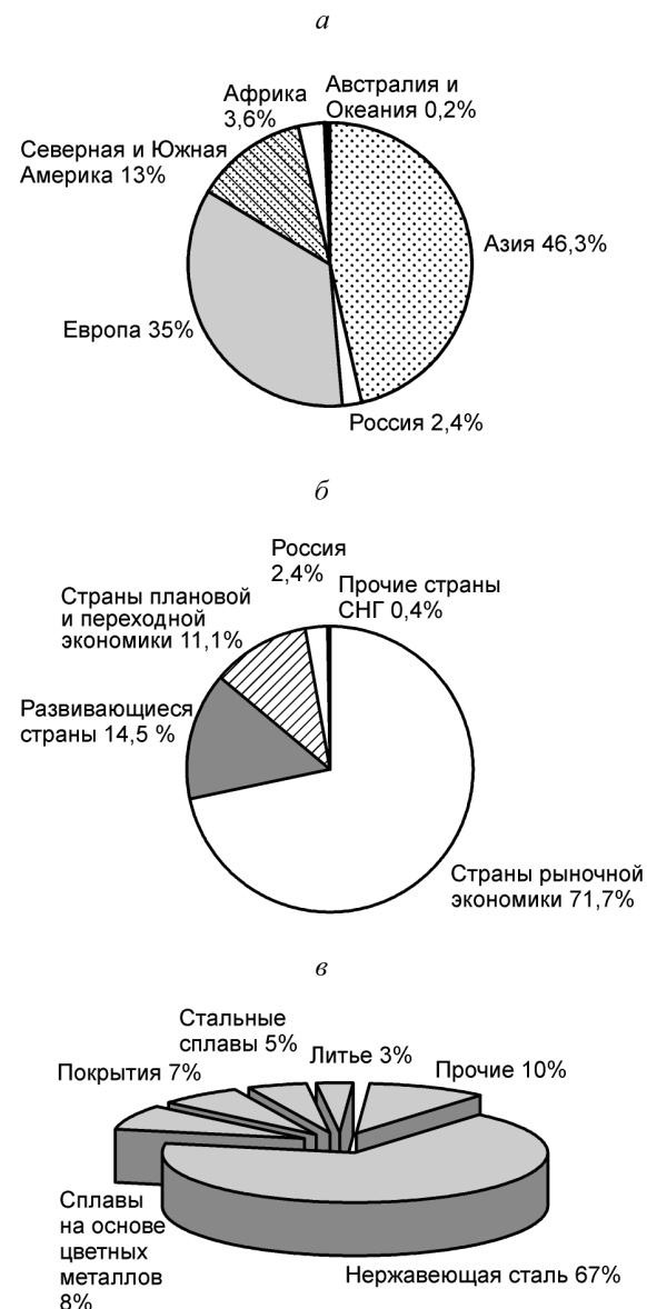
Рис. 20. Структура потребления никеля в 2003–2004 гг. по континентам мира (а), странам с различными типами экономики (б) и областям конечного использования (в), % [5, 6, 23]
