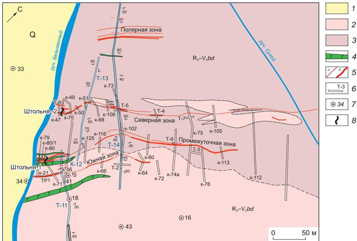
**Рис. 2. СХЕМА ГЕОЛОГИЧЕСКОГО СТРОЕНИЯ ЗОЛОТОРУДНОГО ПРОЯВЛЕНИЯ ВЕРХНЕИЮСКОЕ-2:**
