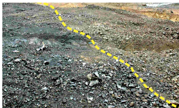
Рис. 6. Зона контакта долеритовых порфиритов с гематит-магнетитовым рудным телом
