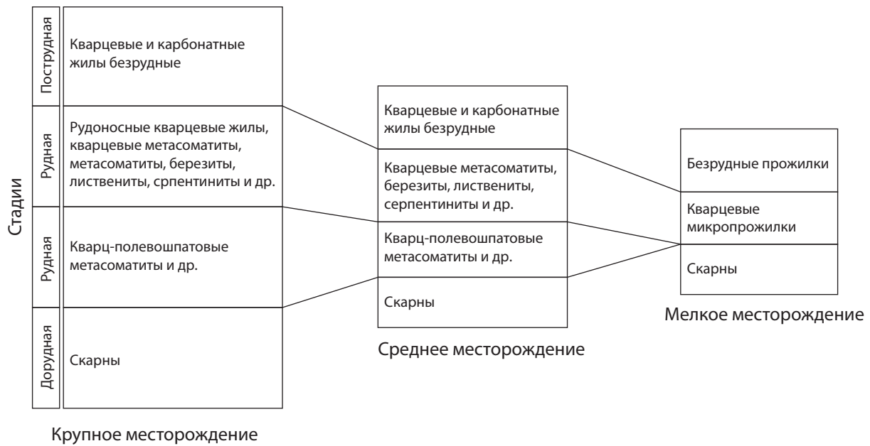
Рис. 8. Принципиальная схема формирования и корреляции крупных, средних и мелких скарновых месторождений золота
