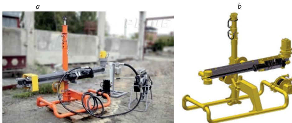
Рис. 5. Общий вид бурового станка: *a* – НБП-65 (ПК «Прайд», г. Челябинск); *b* – БП-65М (АО «Машиностроительный холдинг», г. Екатеринбург)
