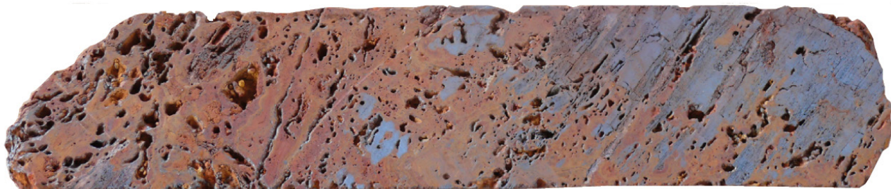
Рис. 11. Замещение полосчатого стально-серого мартита коричневым кавернозным гётитом (Северный Симанду, скв. 039 – 3 м, керн диаметром 72 мм)
